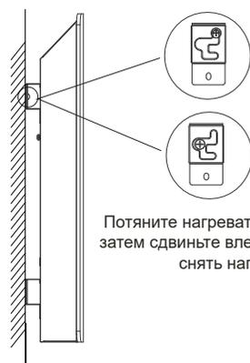
Потяните нагреватель вверх на 5 мм, затем сдвиньте влево на 10 мм, чтобы снять нагреватель.
